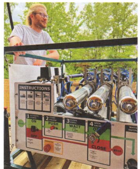
Projektleiter John-Henning Peper erklärt die Wasseraufbereitungsanlage, die autonom funktioniert und mit Materialien überall auf der Welt repariert werden kann. (Foto: Disaster Relief Systems)
